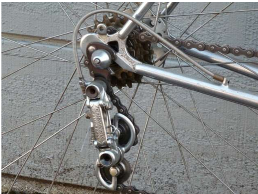
Slika 3: Eden prvih menjalnikov na zadnjem kolesu.
